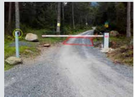
*Im grünen Kreis befindet sich der Wandtaster, im roten Viereck die Induktionsschleife.*
